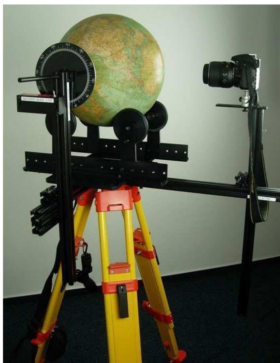
Obr. 1 Mobilní zařízení pro snímkování glóbů
